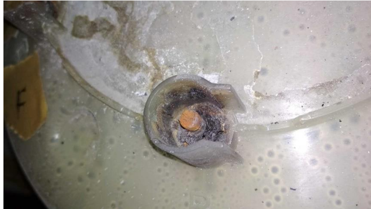
Figura 34. Corrosión en conector de electrodo
