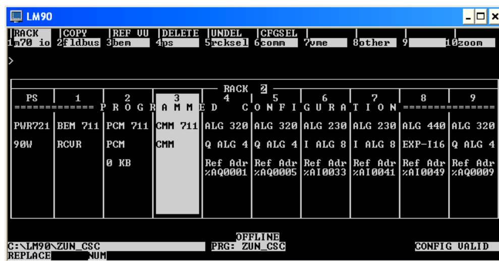
Figura 26. Configuración del módulo de comunicaciones CMM.
