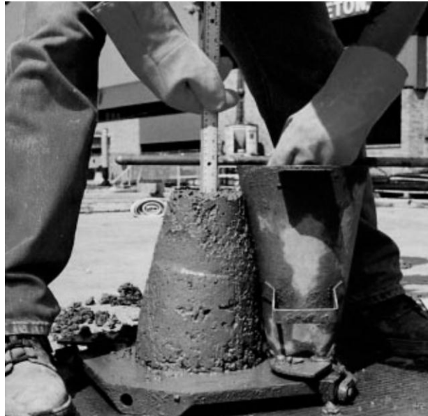
Figura 20. Ensayo de revenimiento
