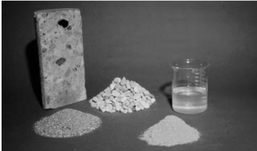
Figura 5. Componentes del concreto: cemento, agua, agregado fino, agregado grueso
