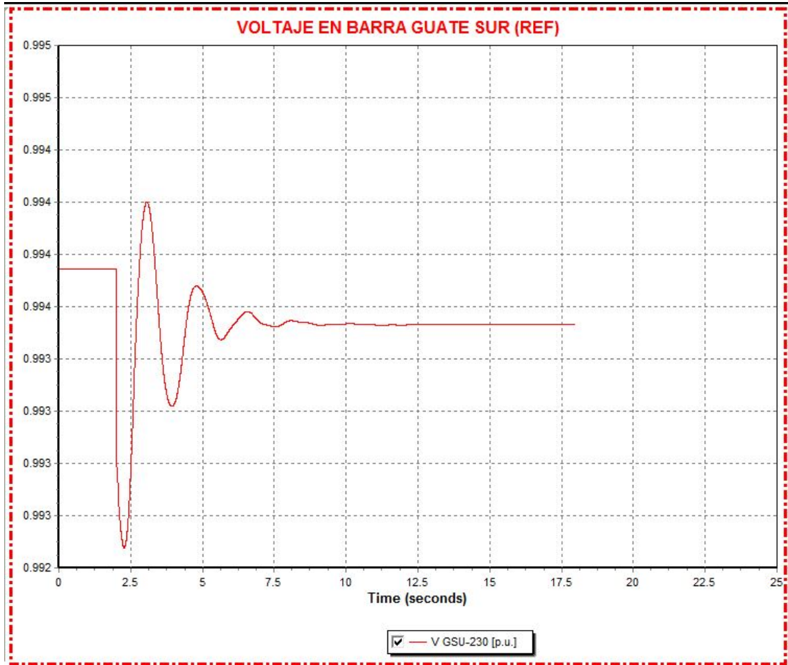
Figura 20. Voltaje en la barra de referencia Guate Sur 230, debido a la desconexión de San Antonio El Sitio
