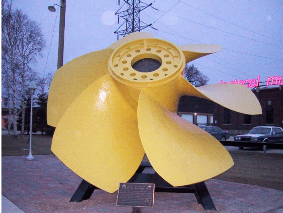
Figura 2. Un rodete de 28,000 hp (cerca de 21,000 KW)
