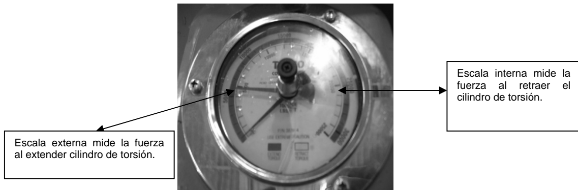
Figura 34. Indicador para medir la torsión.
