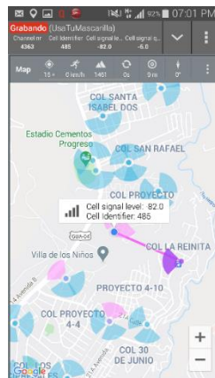
Figura 158. Sector de conexión
