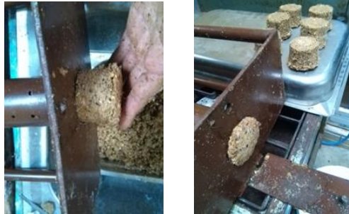
Figura 12. Extracción de la briqueta
