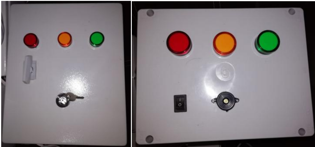
Figura 71. Presentación externa del indicador y alarma de flujo de aire
