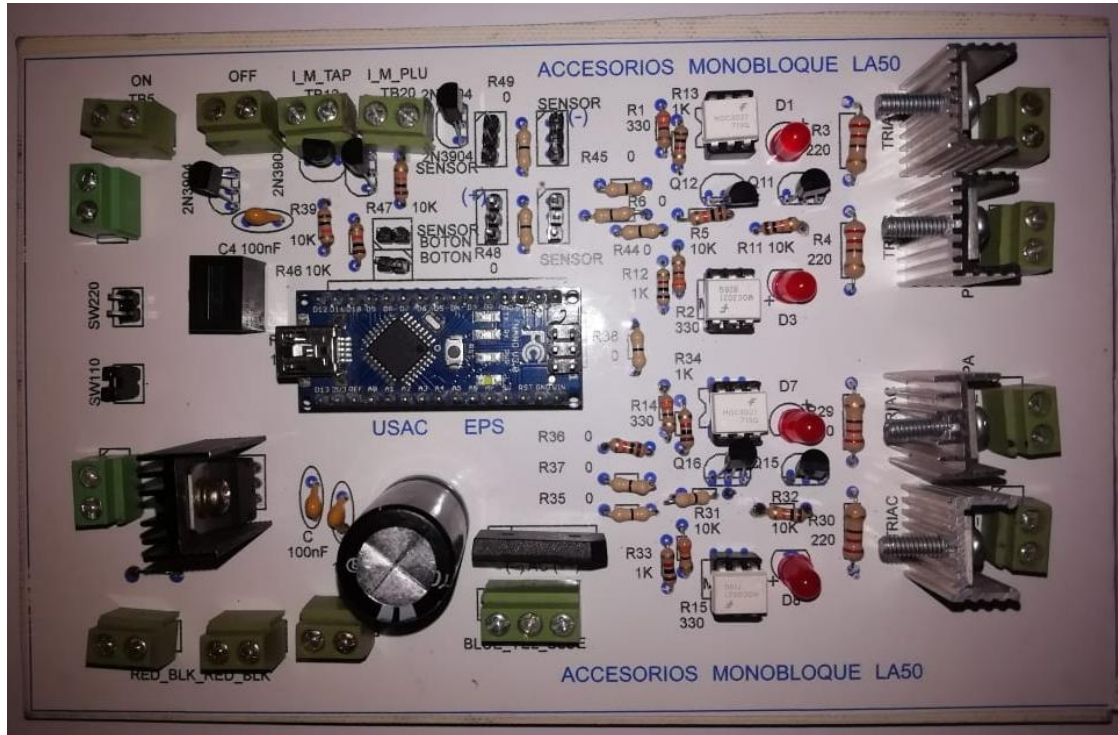
Figura 61. Construcción de placa electrónica del control del sistema neumático y motores alimentadores
