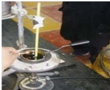
Figura 9. Equipo para el ensayo de punto de inflamación.
