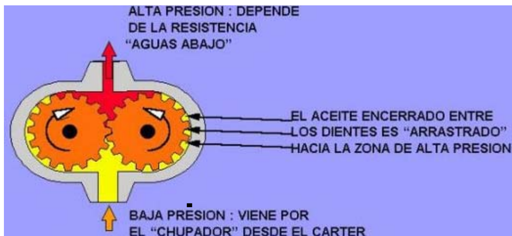
Figura 24. Bomba de presión de aceite
