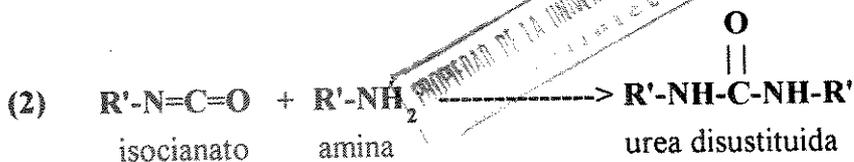
En la polimerización se da la estructura molecular del poliuretano y de acuerdo con los polioles e isocianatos usados en este caso se tendrá una espuma de poliuretano flexible, en una forma esquemática :
