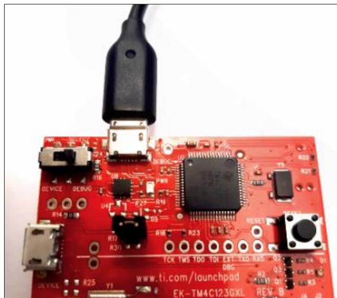
Figura 51. Conexión del cable USB en la Tiva C
