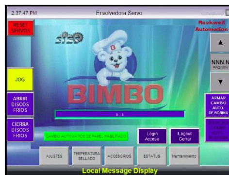
Figura 30. Panel de control de la envolvedora
