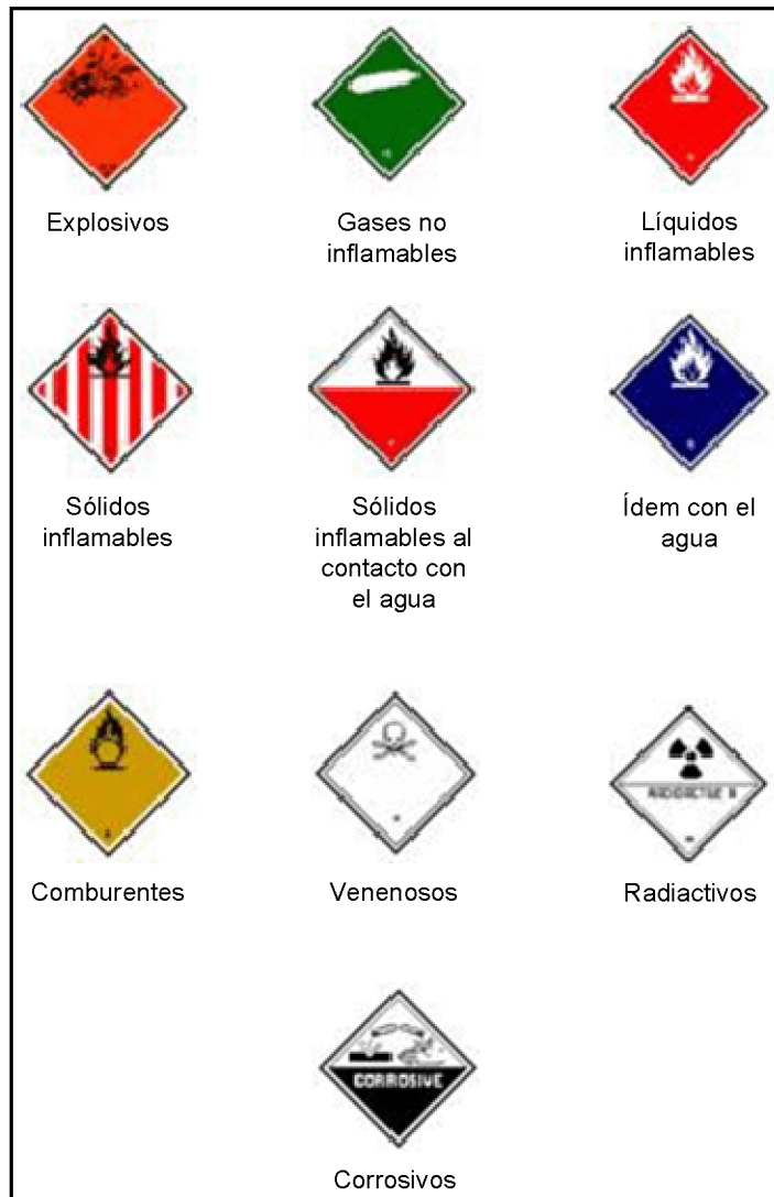
Figura 49. Señalización de sustancias peligrosas
