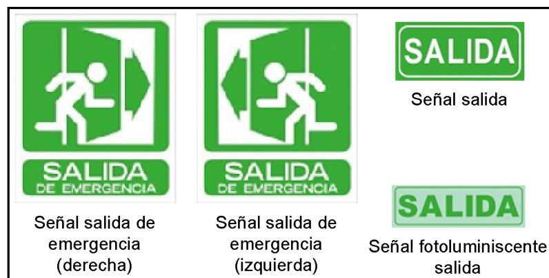
Figura 53. Señales salida de emergencia
