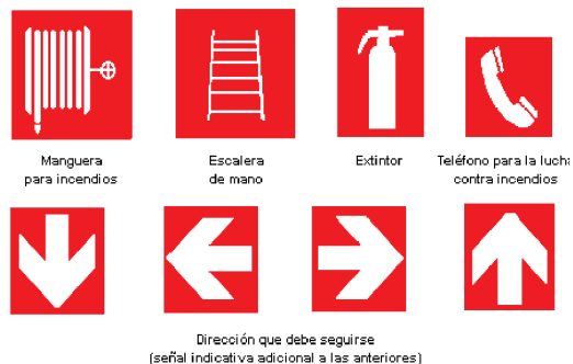
Figura 4. Algunos ejemplos de señalización industrial
