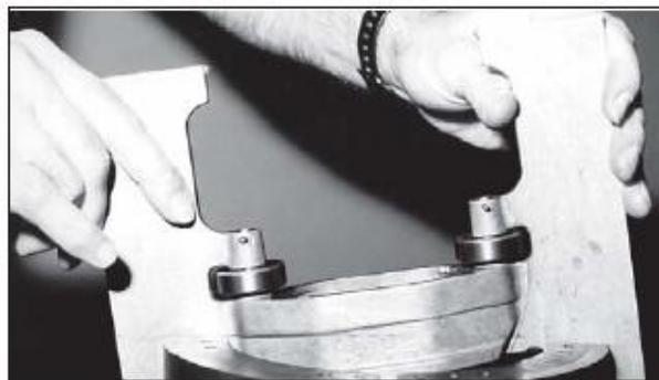
16. Dar la vuelta al rotor para quitar el engranaje del rotor, el cojinete de empuje, y el cojinete superior del rotor. Para quitar, sacar los tornillos de montaje del engranaje del rotor y removerlo. (Figura 61)
