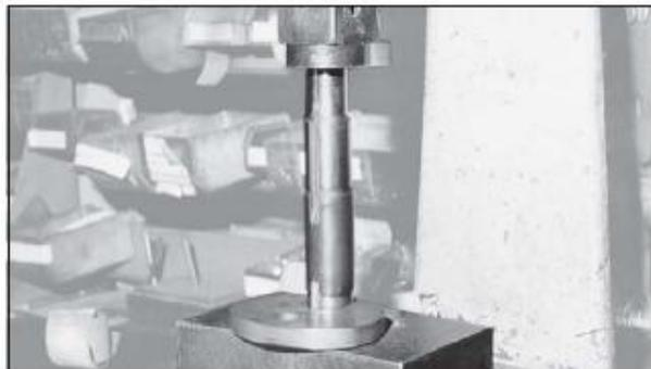
Figura 66. **Montaje del cojinete del rotor sobre el cuerpo del rotor**
