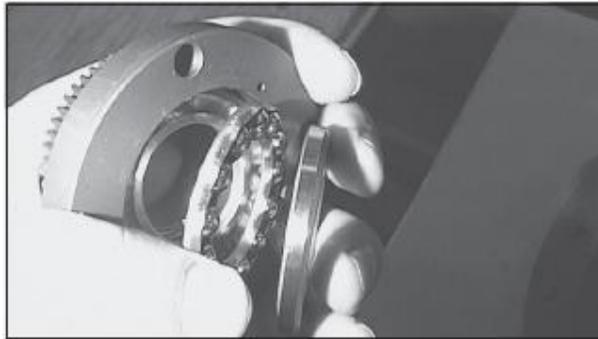
Figura 67. **Montaje del engrane del rotor sobre el cuerpo del rotor**
