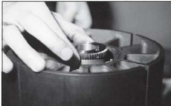
Figura 68. **Instalación de las aletas superiores**
