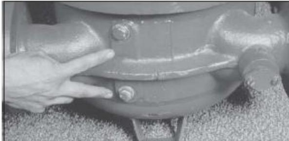
3. Haciendo uso de los ganchos ubicados en la parte superior del contador, levantar el mecanismo del contador de la carcasa. (Figura 49).
