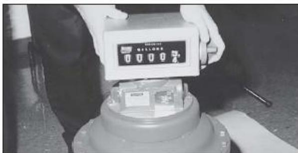
2. Quitar los tornillos de la tapadera y levantar la tapadera principal del contador (Figura 47). Para remover el mecanismo interno, remover los tornillos localizados entre la entrada y salida del contador. (Figura 48).
