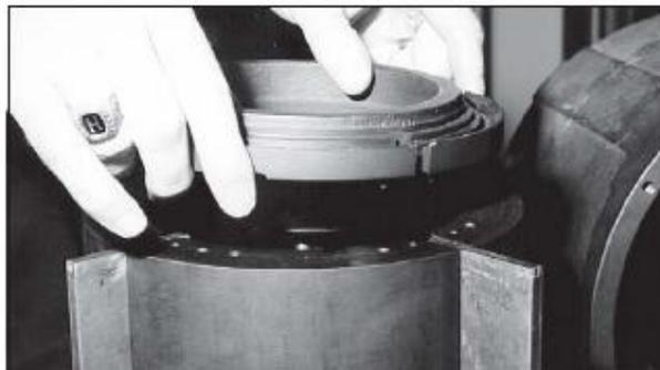
14. Remover el cojinete inferior del rotor, dado sea el caso este permanezca en el mecanismo de la leva y el eje. Levantar la aleta inferior. (Figura 58).
