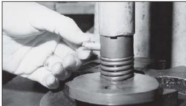
Figura 64. **Deslizar el resorte del eje**
