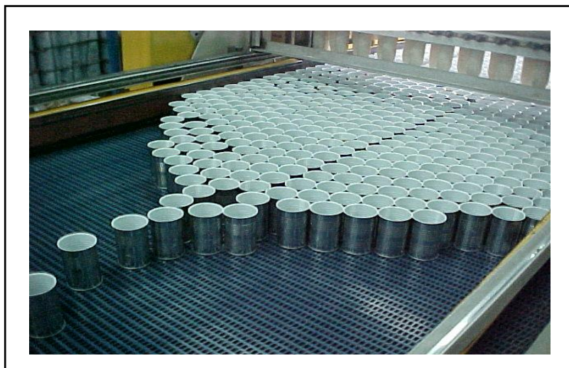
Figura 88. Acumulación de botes en máquina paletizadora
