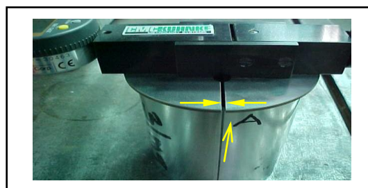
Figura 42. Guía de separación del instrumento alineada con el cordón de soldadura
