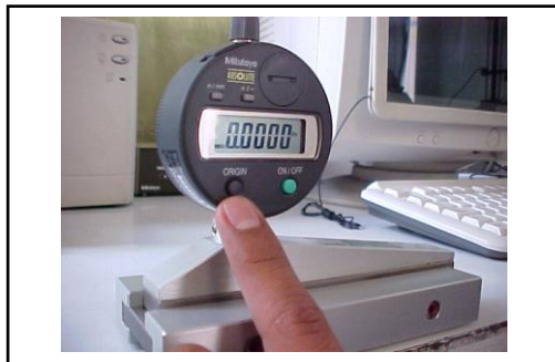
Figura 66. Calibración en cero del medidor de profundidad countersink
