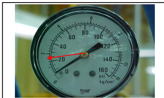
Figura 75. Presión a la que debe trabajar la probadora manual
