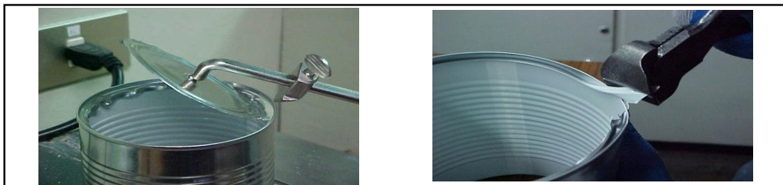
Figura 78. Retiro de materia sobrante
