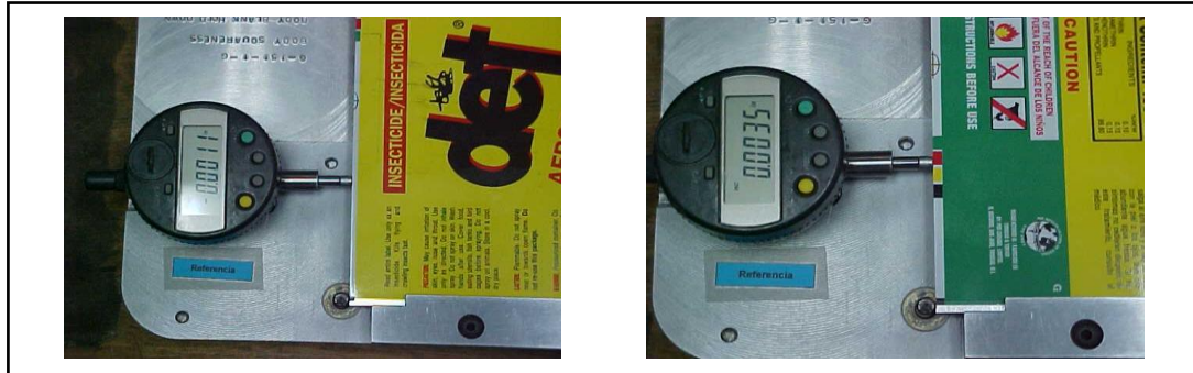
Figura 34. Medición de cuadratura de plantilla
