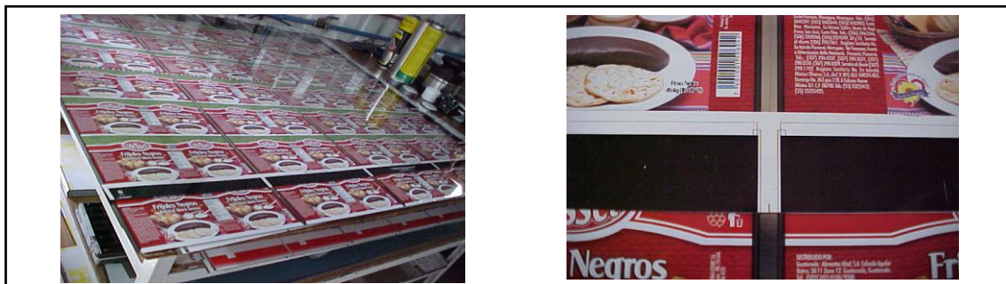
Figura 38. Utilización de escantillón del lado con litografía
