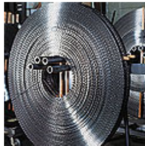
Figura 19. Rollo de sierra de cinta
