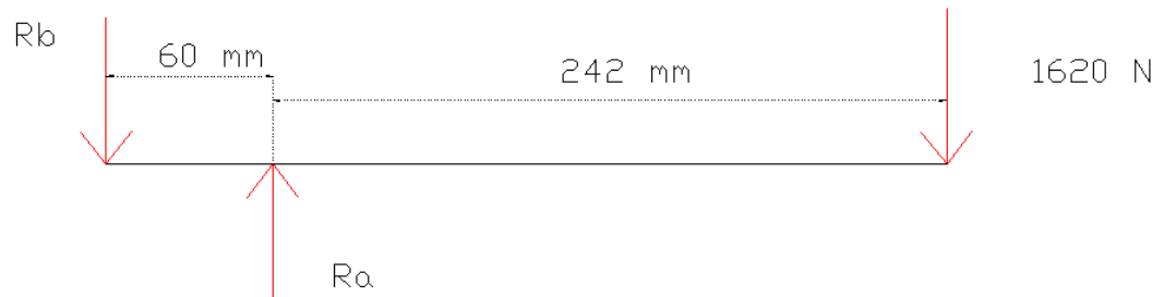
Figura 53. Diagrama de cuerpo libre idealizado del eje y el tubo rectangular plano X-Z
