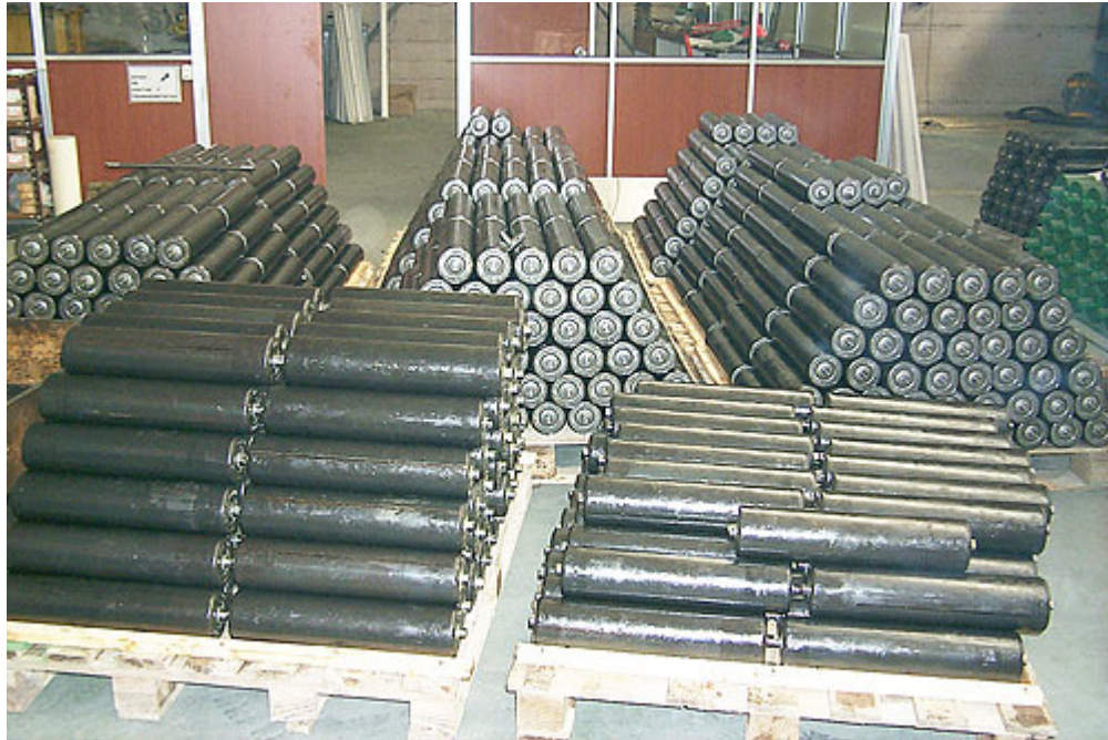
Figura 60. Rodillos libres de una banda
