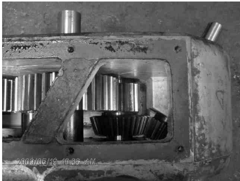
Figura 9. Interior de caja reductora de velocidad correspondiente a rodos superiores de enderezadora SUTTON.
