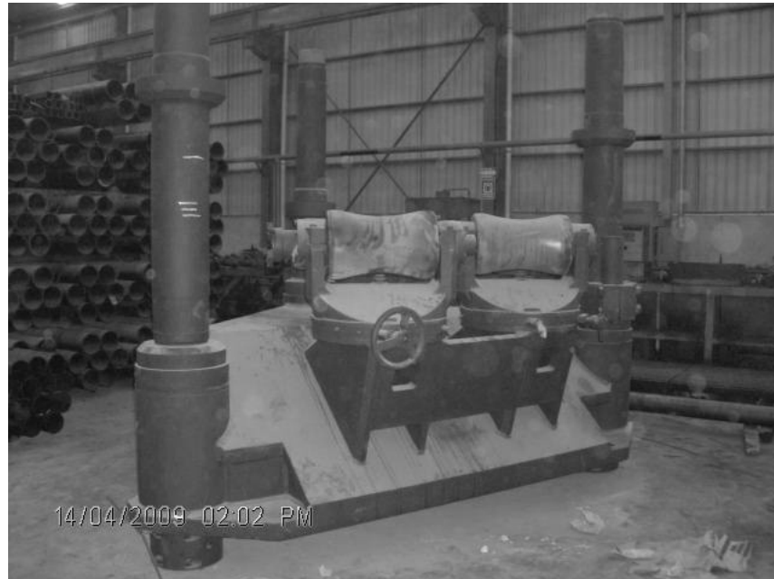
Figura 5. Fotografía de la base de la máquina enderezadora SUTTON.
