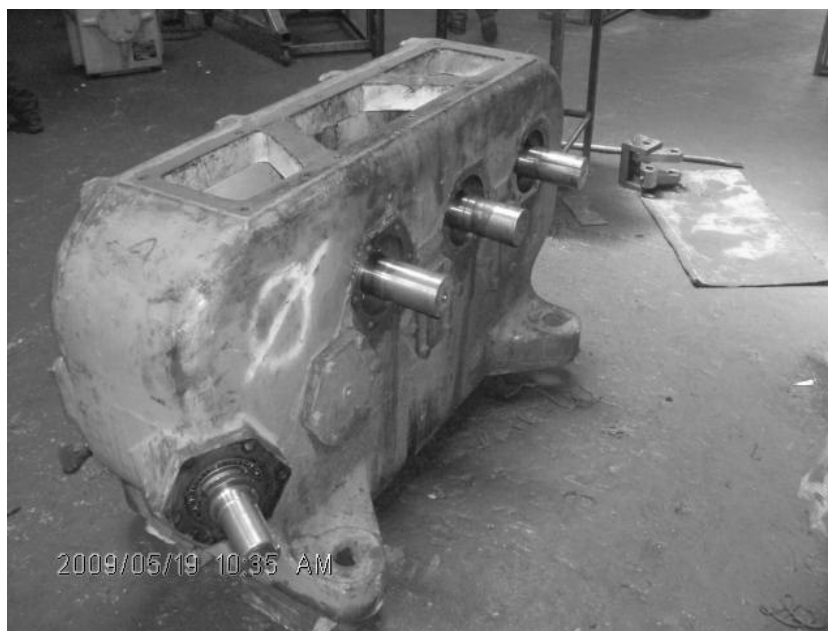
Figura 8. Caja reductora de velocidad correspondiente a los rodos superiores de la enderezadora SUTTON.
