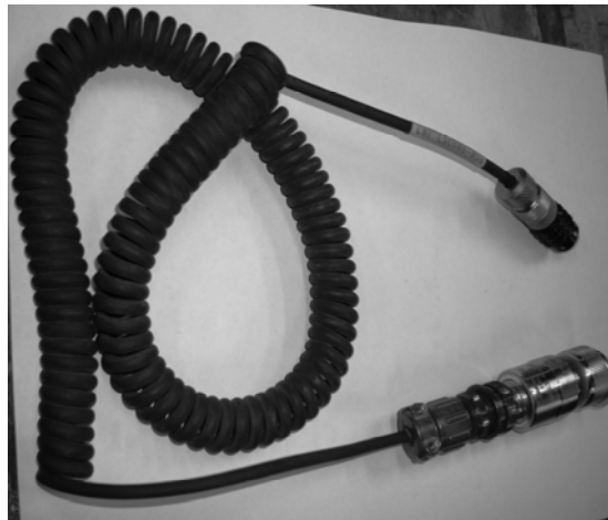
Figura 23. Cable del acelerómetro.
