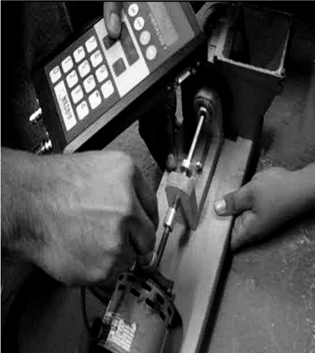
Figura 18. Medición en el cojinete del motor en prototipo motor con eje y tolva.
