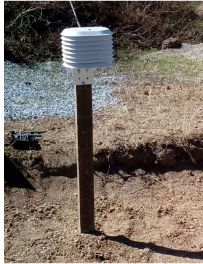
Sensor de temperatura instalado fuera de la laguna
