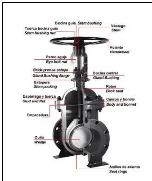
Figura 26. Válvula de compuerta y sus partes
