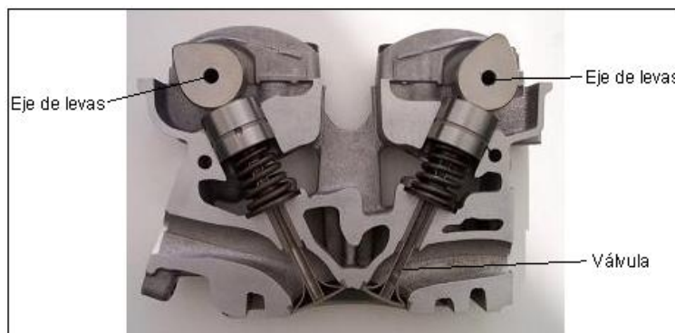
Figura 12. Eje de levas a la cabeza
