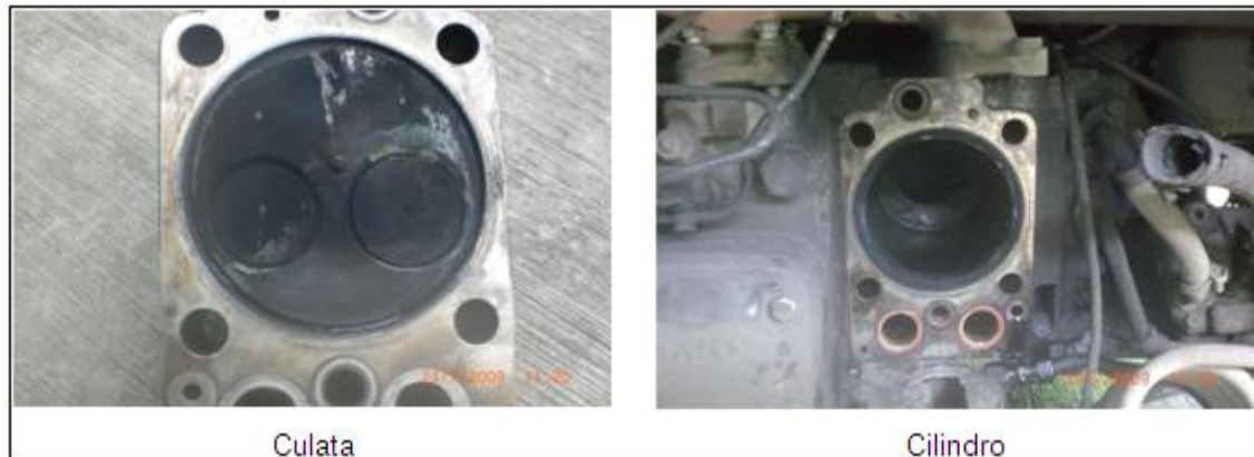
Figura 36. Tercera levantada de culata
