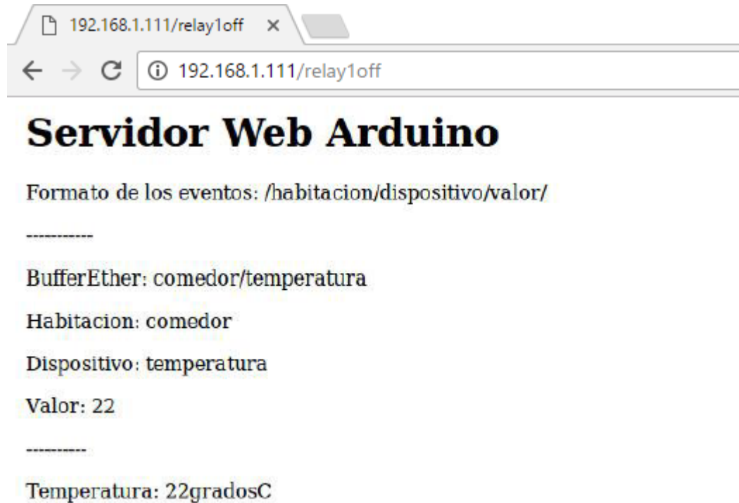
Figura 19. Comunicación con el sistema utilizando protocolo HTTP
