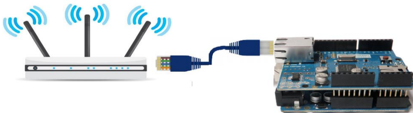
Figura 15. Arduino Ethernet Shield acplado y Arduino UNO conectado a router
