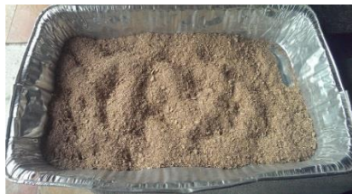
Figura 14. Mezcla horneada de aserrín tamizado con 40 % aglutinante de almidón de yuca
