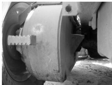
Se deben de quitar los respiraderos y limpiarlos con solvente, los cuales no deben de quedar tapados. Se le agrega aceite, consultar la tabla de capacidad de llenado y se verifica con la varilla de medición; tiene que quedar entre las marcas de añadir y lleno (Fig. 43).
