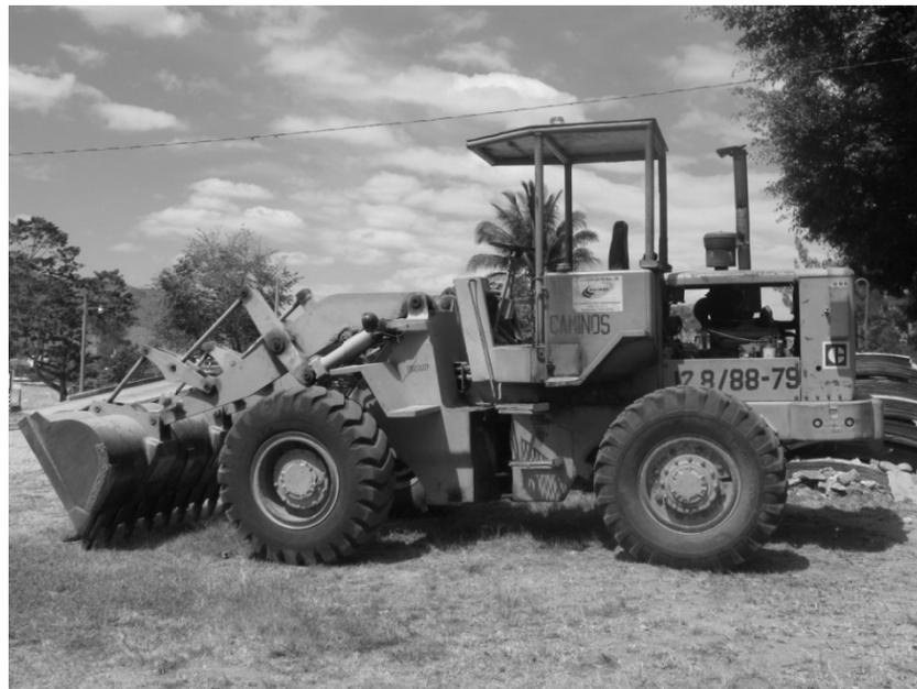
En los cargadores, la altura de descarga es la distancia vertical desde el suelo al punto más bajo en la cuchilla o dientes del cucharón, cuando este está inclinado a cuarenta y cinco grados. Esto determina la altura a la que se puede despejar al retroceder desde un camión o una tolva con el cucharón en la posición de descarga.
