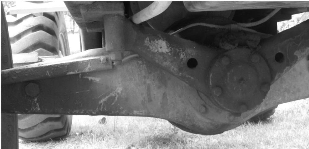
En las motoniveladoras, es necesario cambiar el aceite del mecanismo de giro de la tornamesa (Fig. 41), drenando el aceite por medio del tornillo de drenaje, y llenarlo según la tabla de capacidad de llenado por medio del tornillo de llenado, que se encuentra en la parte superior.
