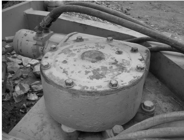
En las motoniveladoras, también debe de cambiarse el aceite de los tándem, el cual lleva uno a cada lado de la máquina (Fig. 42). Se debe de quitar el tornillo de drenado que se encuentra en la parte inferior de cada tándem, luego se limpian y se vuelven a colocar.
