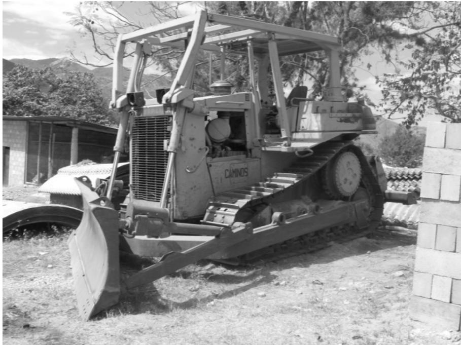
Cuando un tractor está equipado con topadora (bulldozer), puede optar por un sin número de aplicaciones, pero en realidad se utiliza cuando la potencia requerida es grande y las distancias de acarreo son cortas, o bien en donde las pendientes o las condiciones del suelo no permiten trabajar con otra maquinaria. En realidad, este tipo de tractor es el primero que entra al trabajo, pues con él se realizan los trabajos de limpia, chapeo y destronque, y de allí se pasa al corte.
