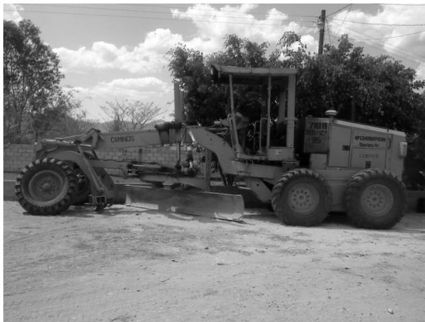
Las motoniveladoras están equipadas con una cuchilla montada sobre una tornamesa, un riper y un escarificador; utilizan neumáticos y poseen en muchos casos un bastidor articulado (Fig. 20).
