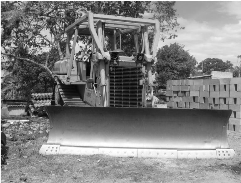
Los sistemas de dirección del diferencial funcionan a plena potencia en cada giro de ambas cadenas, para mover mayores cargas a menores velocidades. Se mantiene una potencia interrumpida en ambas cadenas por medio de una impulsión mecánica directa. El tractor gira aumentando y disminuyendo por igual las velocidades de una y otra cadena. La diferencia de velocidades hace girar al tractor (Fig. 18).
