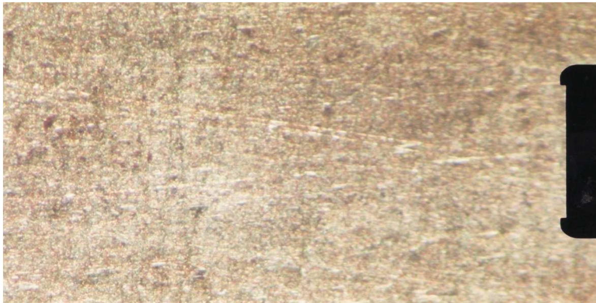
Figura 56. Fotomicrografía de acero AISI 1045, E-7018 magnificación en el microscopio: 100x.
