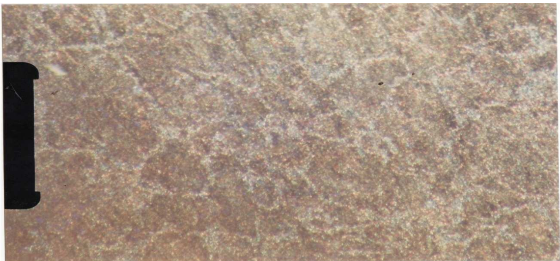
Figura 47. Fotomicrografía de acero AISI 1018 con magnificación en el microscopio: 20x.
