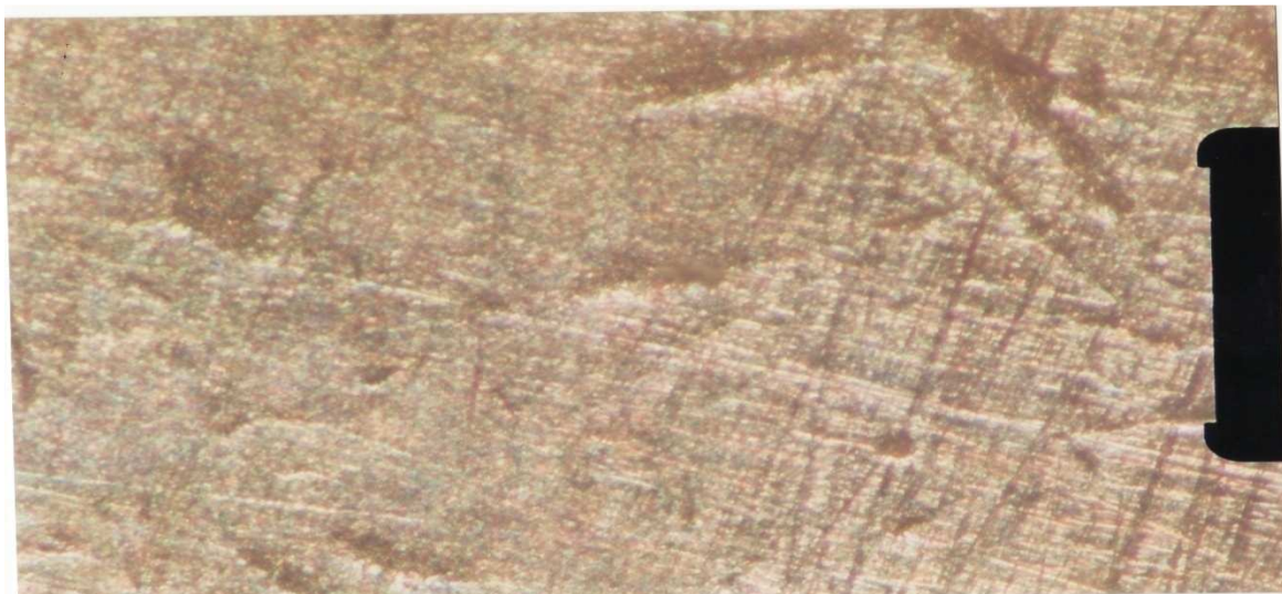
Figura 49. Fotomicrografía de acero AISI 1018, E-6013 magnificación en el microscopio: 50x.
