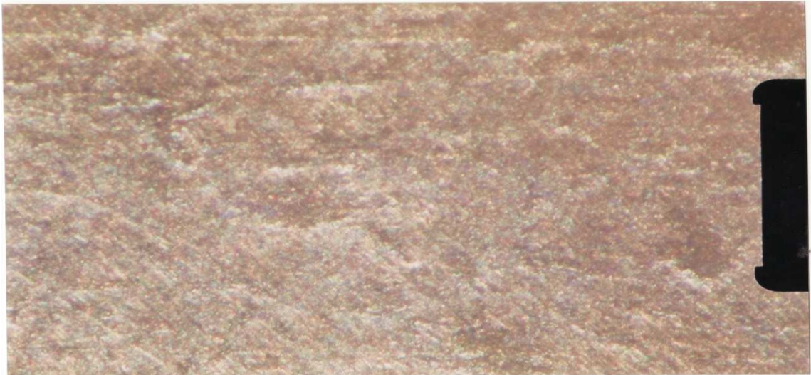
Figura 54. Fotomicrografía de acero AISI 1045, E-6013 magnificación en el microscopio: 100x.
