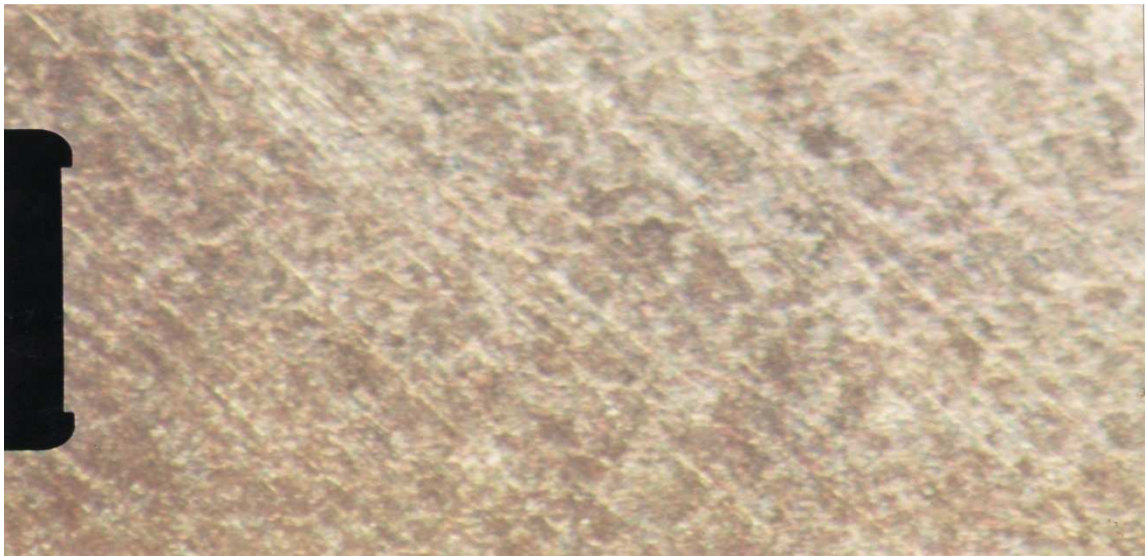
Figura 55. Fotomicrografía de acero AISI 1045, E-7018 magnificación en el microscopio: 50x.
