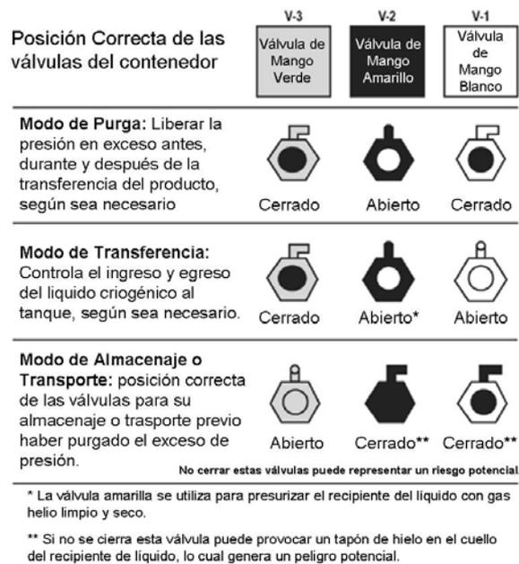
Para transferir helio líquido entre tanques, se deben colocar las válvulas de la siguiente manera para que fluya a través, la válvula V-1 (blanco), V-3 (verde) están cerradas y la válvula V-2 (amarillo) se debe abrir para que ejerza presión sobre el recipiente con líquido limpio y seco de gas helio. Cuando el recipiente esta presurizado al nivel deseado se puede iniciar la transferencia de helio líquido.
