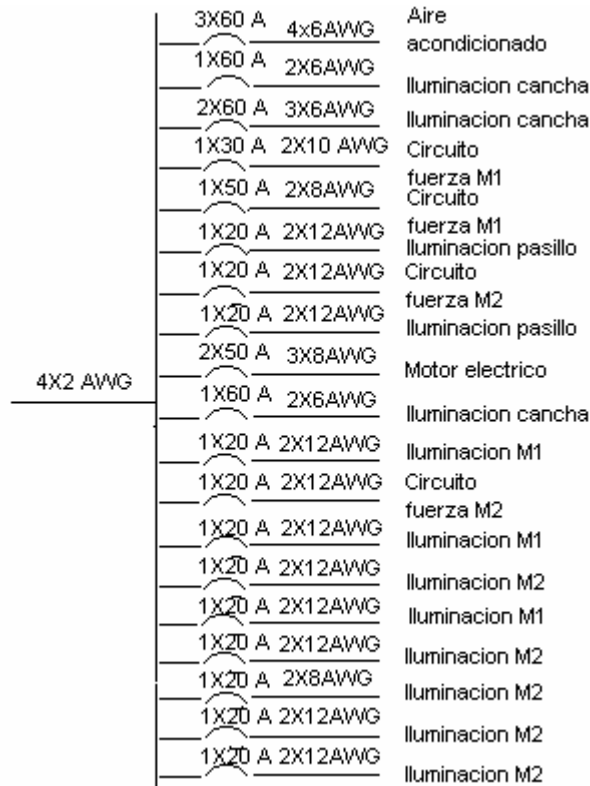
Figura 44. Diagrama unifilar final del tablero A (Módulos 1 y 2)
