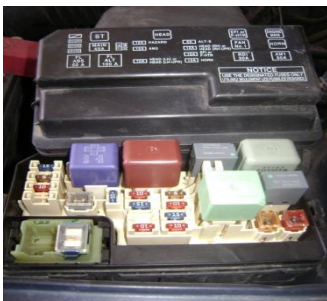
Figura 47 Caja de Fusibles
