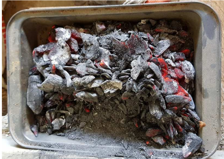
Figura 16. Carbón generado por la combustión de cáscara de Coco
