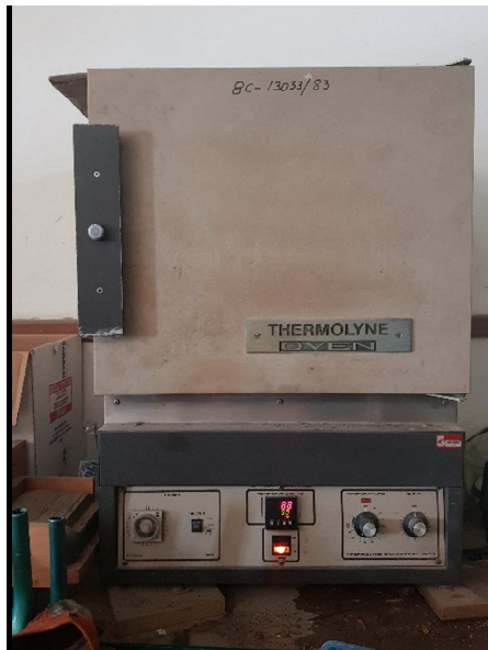
Figura 25. Horno de secado utilizado para la determinación de la humedad de la cáscara de coco
