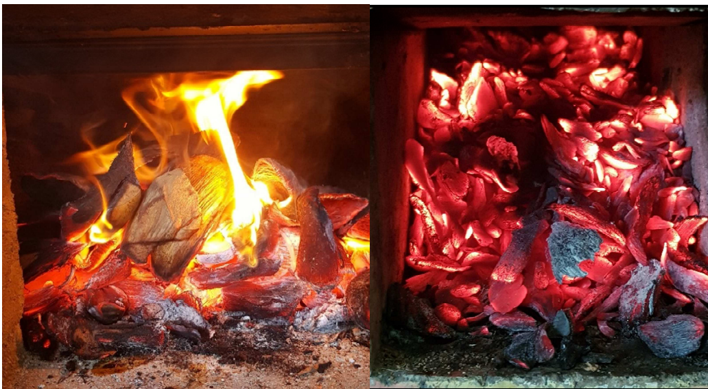
Figura 11. Llama y carbón generado durante el proceso de combustión de cáscara de coco
