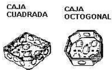
Figura 6. Cajas de conexión
