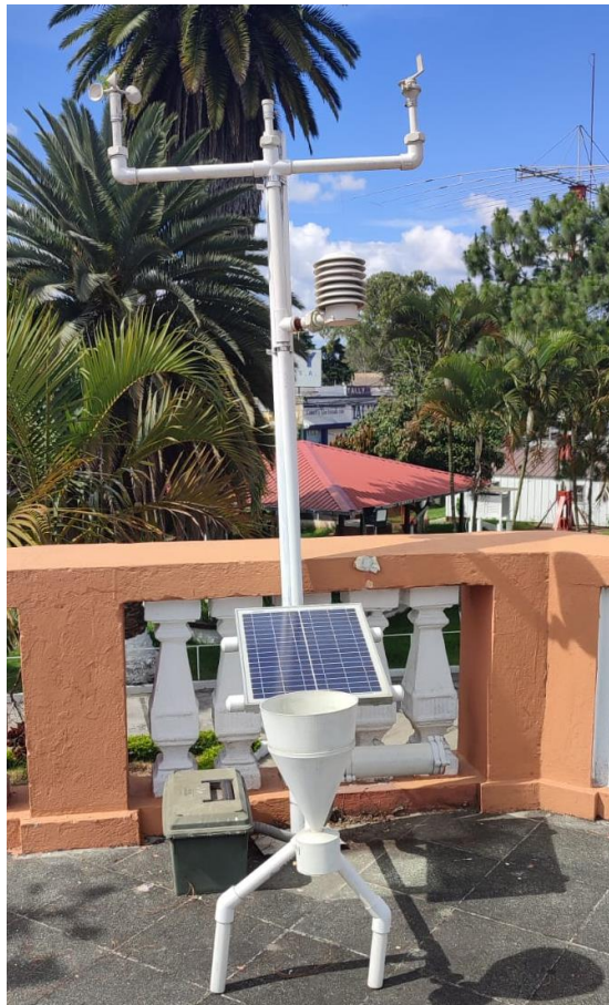
Figura 127. Estructura inicial estación meteorológica impresa en 3D
