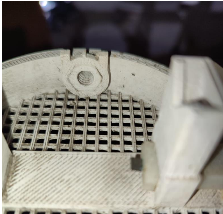
Figura 44. Topes desgastados para calibración de toma de datos sobre precipitación
