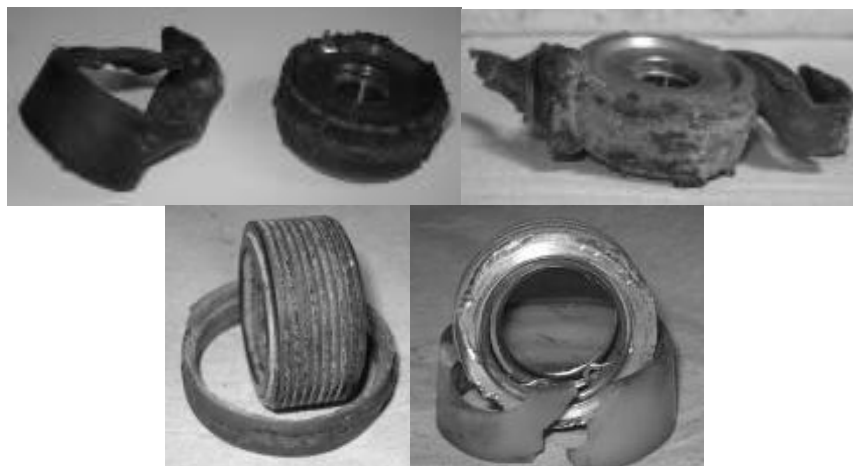
Figura 87. Falla de rueda de leva
