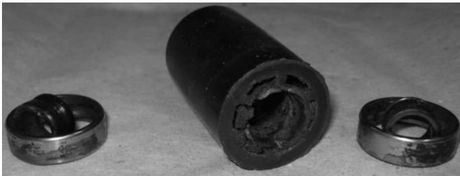
Figura 90. Falla del cojinete de rodillo de leva
