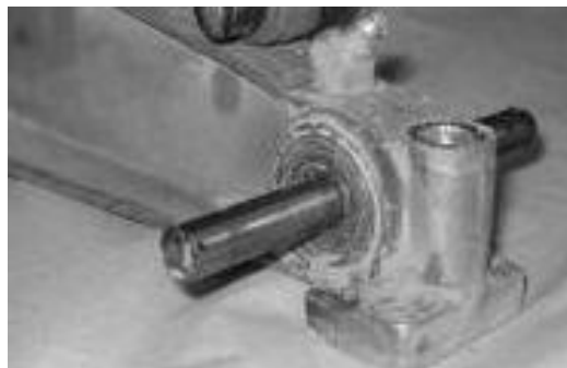
Figura 88. Falla de rodillo de levas
