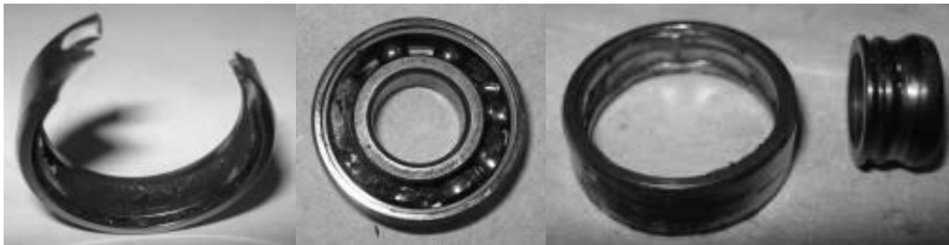
Figura 85. Cojinete de levas destruido
