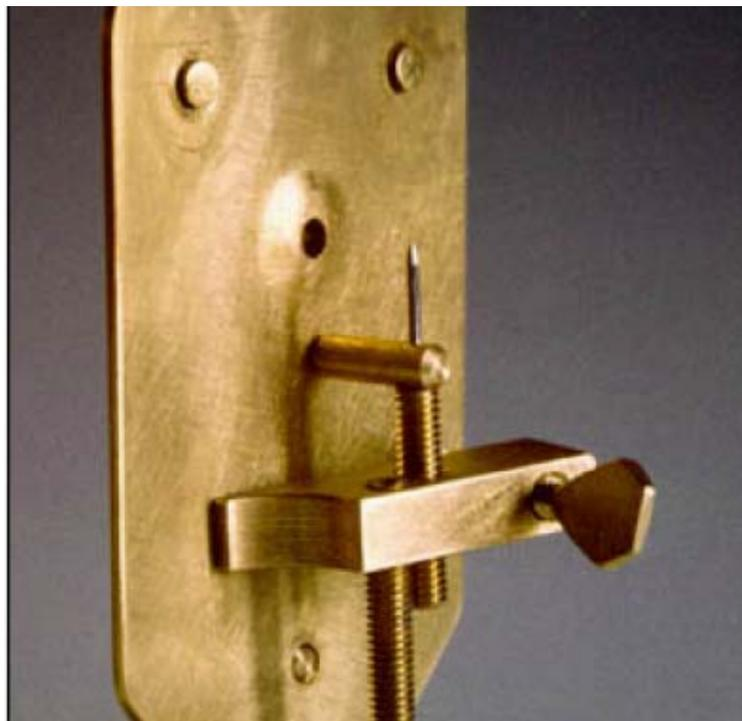
El factor limitante en el microscopio de Van Leeuwenhoek era la calidad de la lente convexa. El problema se pudo resolver con la adición de otra lente, para ampliar la imagen producida por la primera lente. Este microscopio compuesto formado por una lente objetiva y un ocular, junto con medio para el enfoque, un espejo o una fuente de luz y un soporte para sujetar y colocar el espécimen es la base de los microscopios ópticos actuales.
