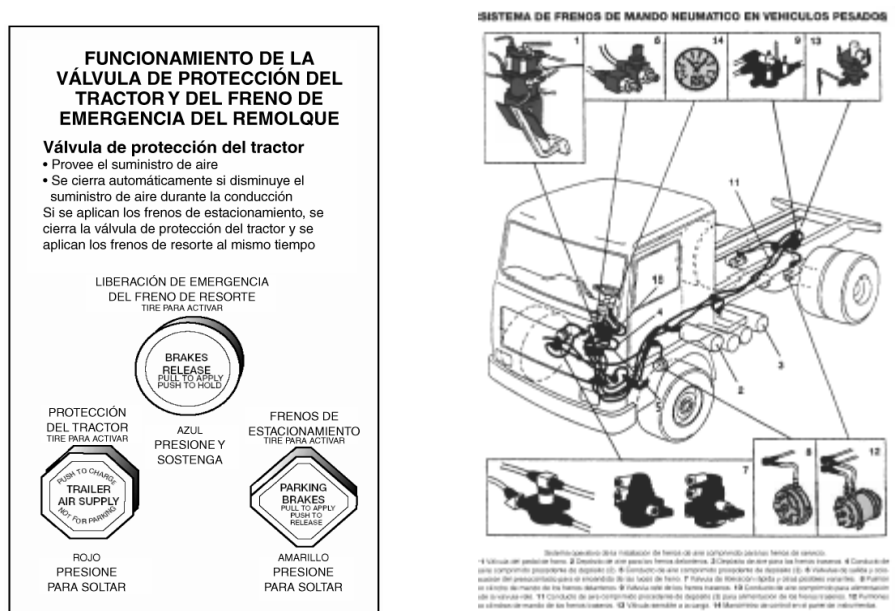
Figura 58. Tipos de válvulas de estacionamiento y ubicación de los componentes del sistema de frenos neumáticos
