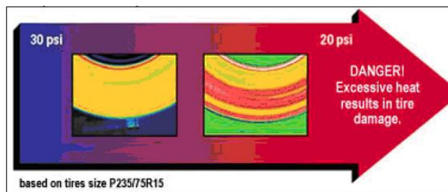
Figura 79. Incremento de la temperatura del neumático por baja presión
