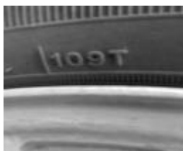
Figura 80. Código de velocidad e índice de carga en el neumático
