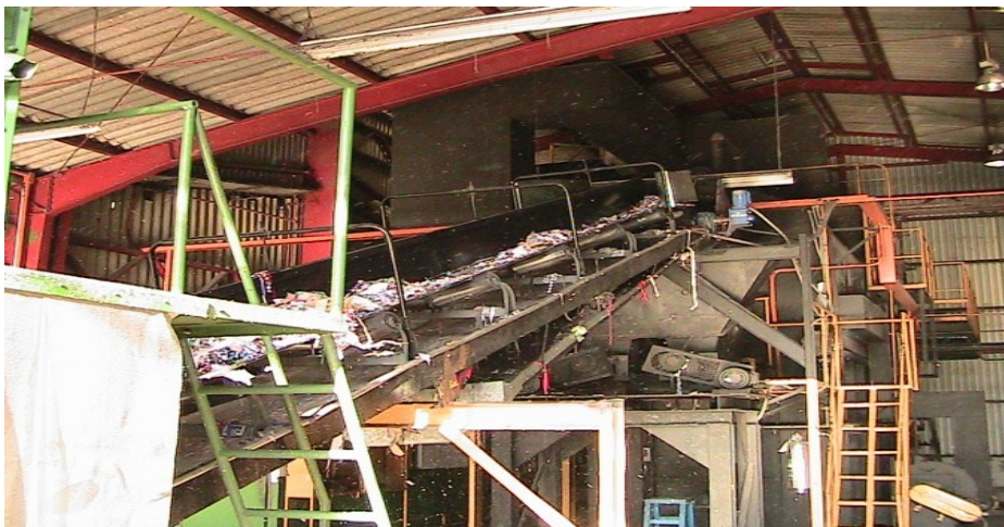
Figura 18. Sistema de alimentación de fibra de palma
