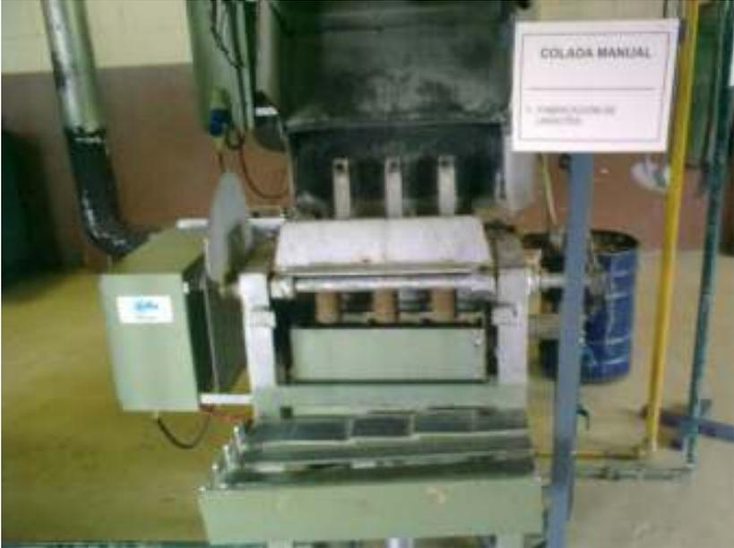
**Corte del lingote de plomo**
