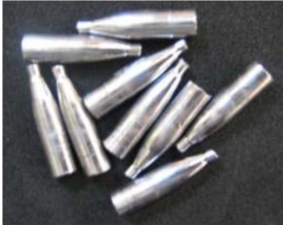
**Abrillantado del núcleo de plomo**
