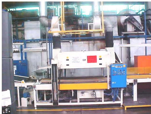
Figura 9. Horno de 7 lámparas UV
