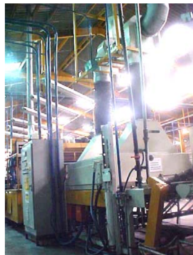
Figura 8. Horno de 4 lámparas UV lado trasero
