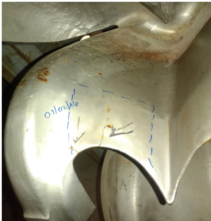
Figura 8. Fisuras- fatiga corrosión
