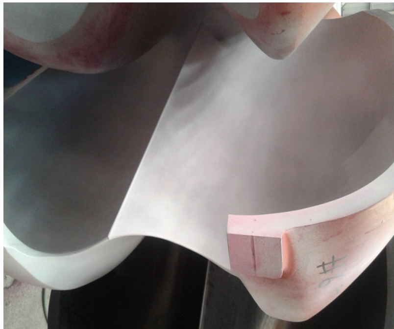
Figura 79. Ensayo no destructivo por líquidos penetrantes a soldadura
