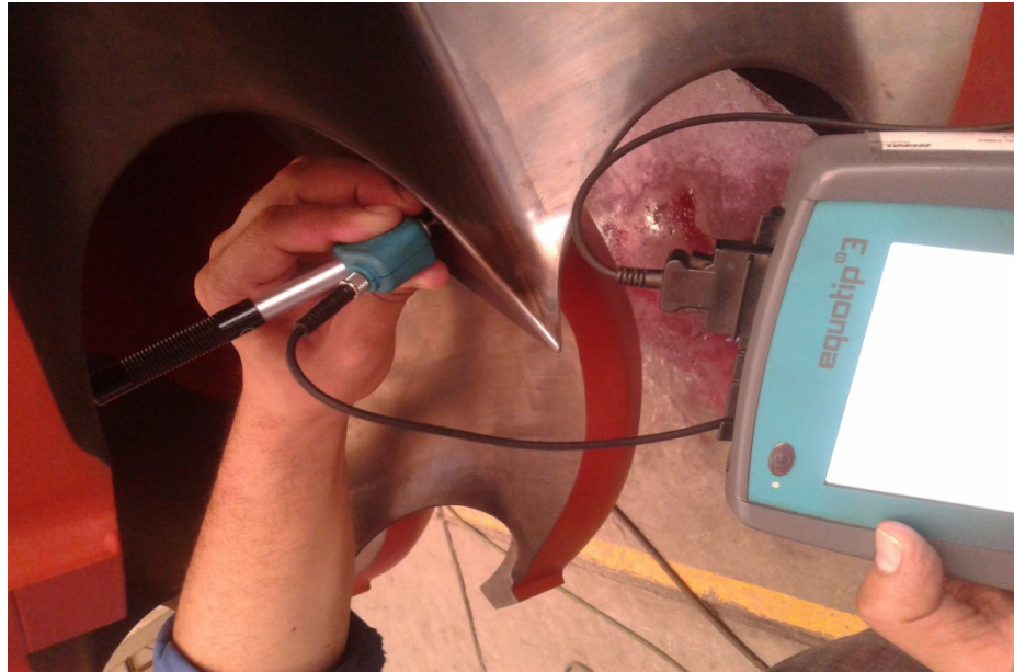
Figura 82. Ensayo de dureza a Cangilón con soldadura aplicado
