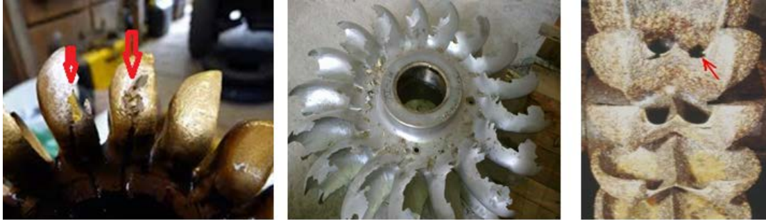
Figura 56. Daños por operación de rodetes
