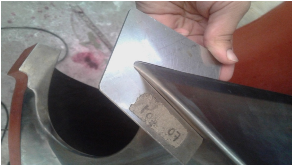
Figura 78. Revisión de perfiles con plantillas
