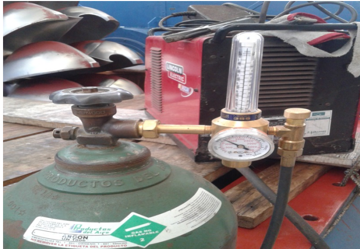
Figura 25. Gas de protección argón y (CO 2 )
