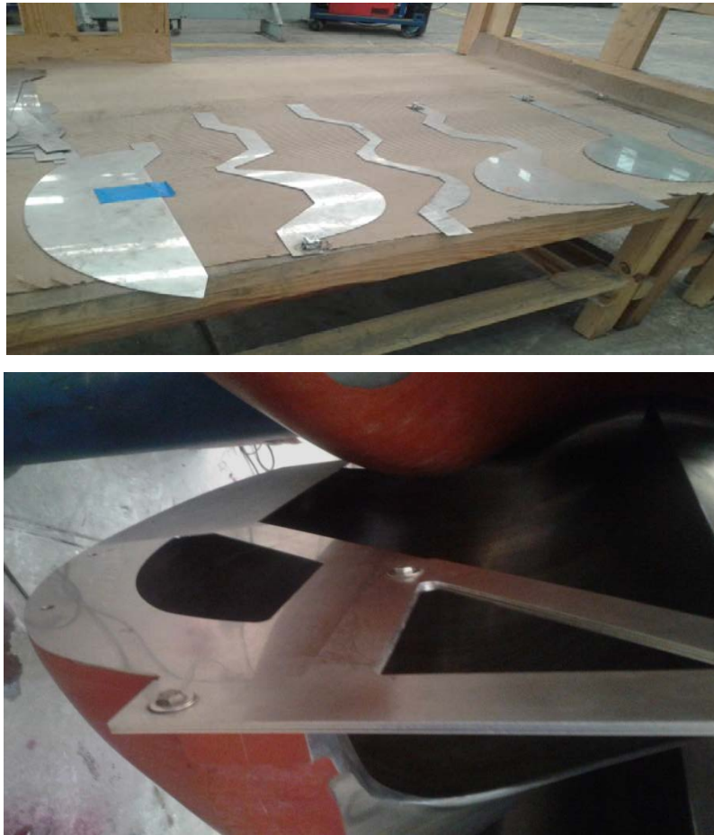
Figura 61. Plantillas de desgaste de cangilón de rodete Pelton
