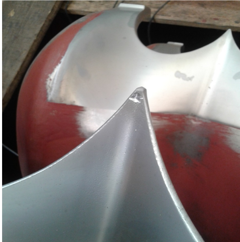
Figura 69. Preparación de daño previo a soldadura
