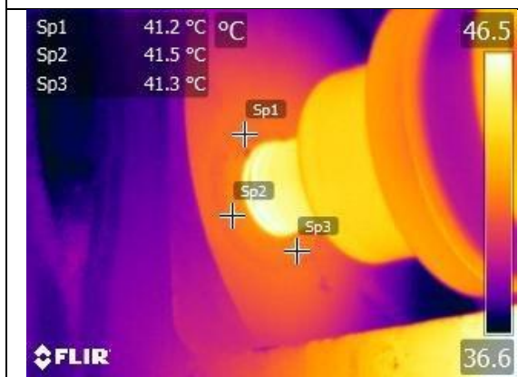
Imagen IR, cojinete de carga
