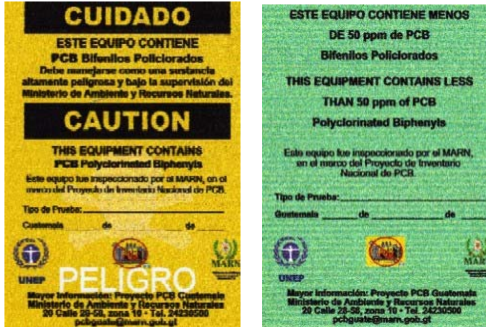
Figura 26. Etiquetas para identificar el contenido de PCB en equipos analizados.
