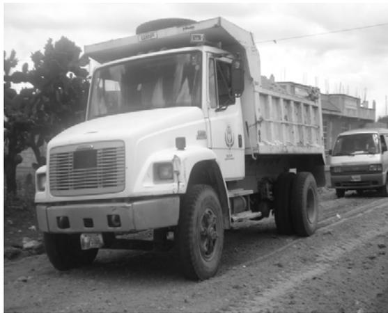
Figura15. **Camión de volteo, marca Mercedes Benz, modelo 1995, diesel de combustible**
