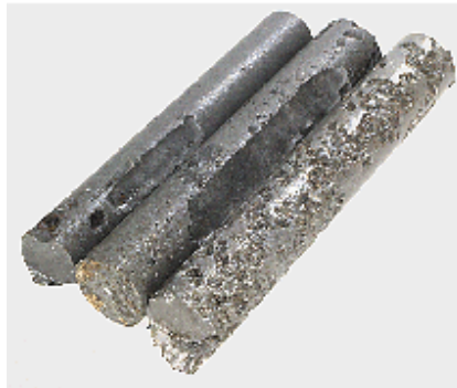
Figura 7. Desgaste por corrosión
