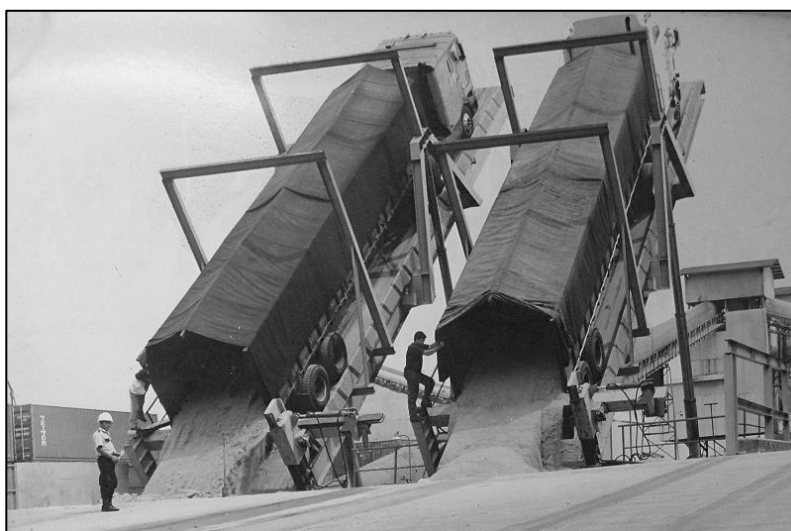
Figura 6. Recepción de azúcar en puentes hidráulicos
