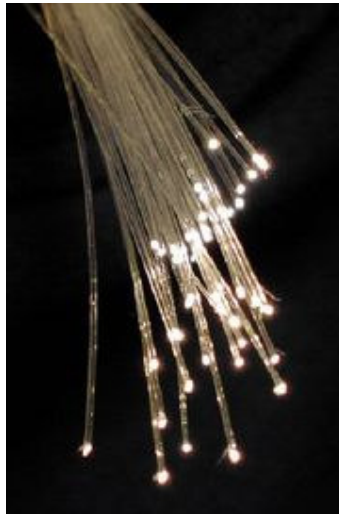
Figura 4. Fibra óptica brillando cuando transmite luz.
