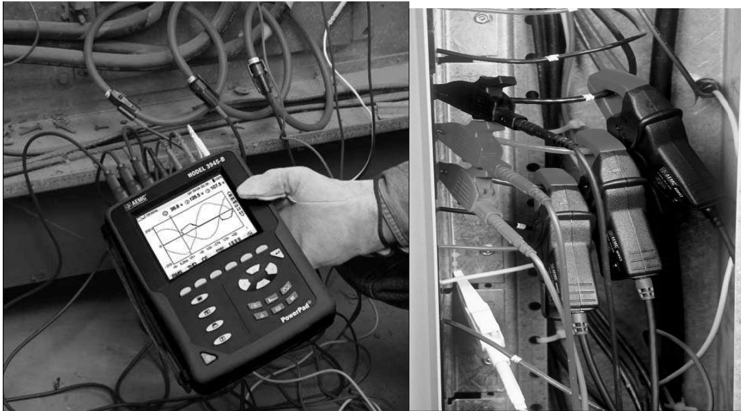
Figura 21. Manera de conectar los Cts y Pts
