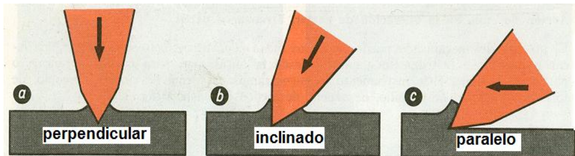
Figura 3. Acción de recalcado o aplastamiento de la cuña
