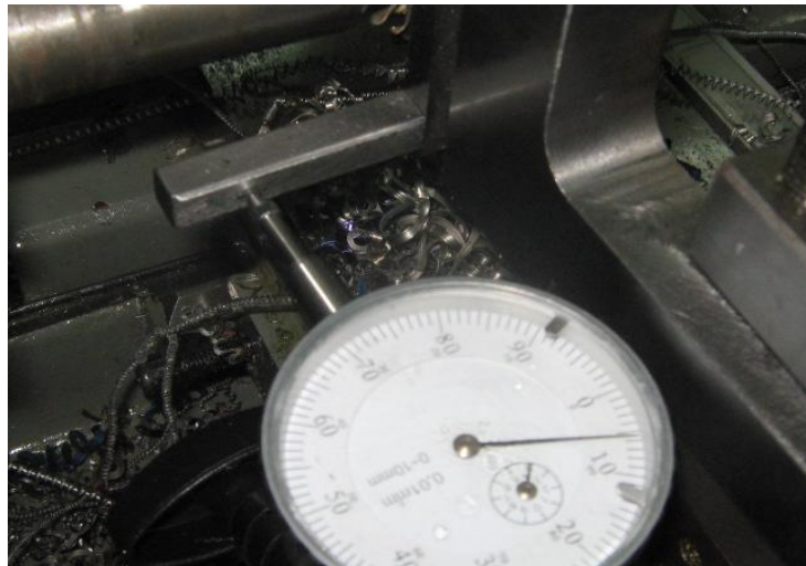
Figura 104. Deformación del dinamómetro con buril de Co al 5% con w = 4 mm
