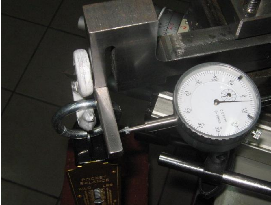
Figura 85. Deformación del dinamómetro con peso de 28 kgf
