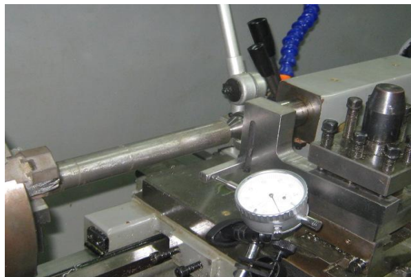
Figura 95. Montaje del reloj comparador para la prueba del dinamómetro
