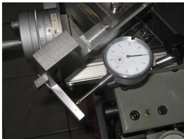
Figura 80. Colocación del reloj comparador respecto al dinamómetro
