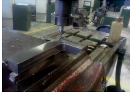
Figura 69. Mecanizado de rebaje para la sujeción del dinamómetro en el torno
