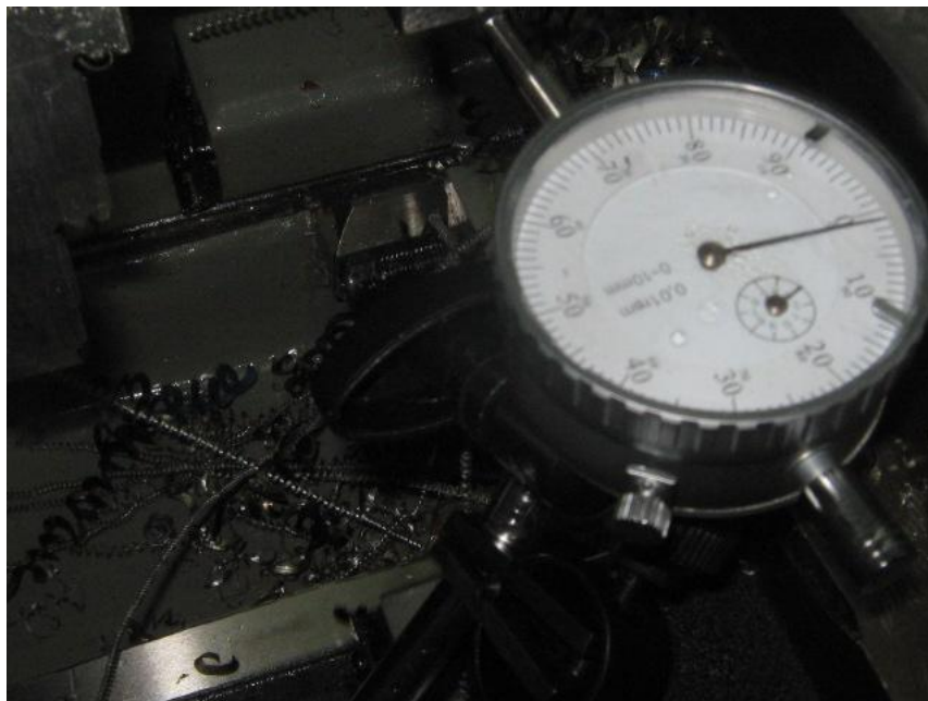
Figura 105. Deformación del dinamómetro con buril de W con w = 1 mm
