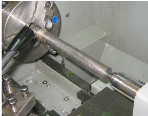
Figura 93. Montaje del material para la prueba del dinamómetro
