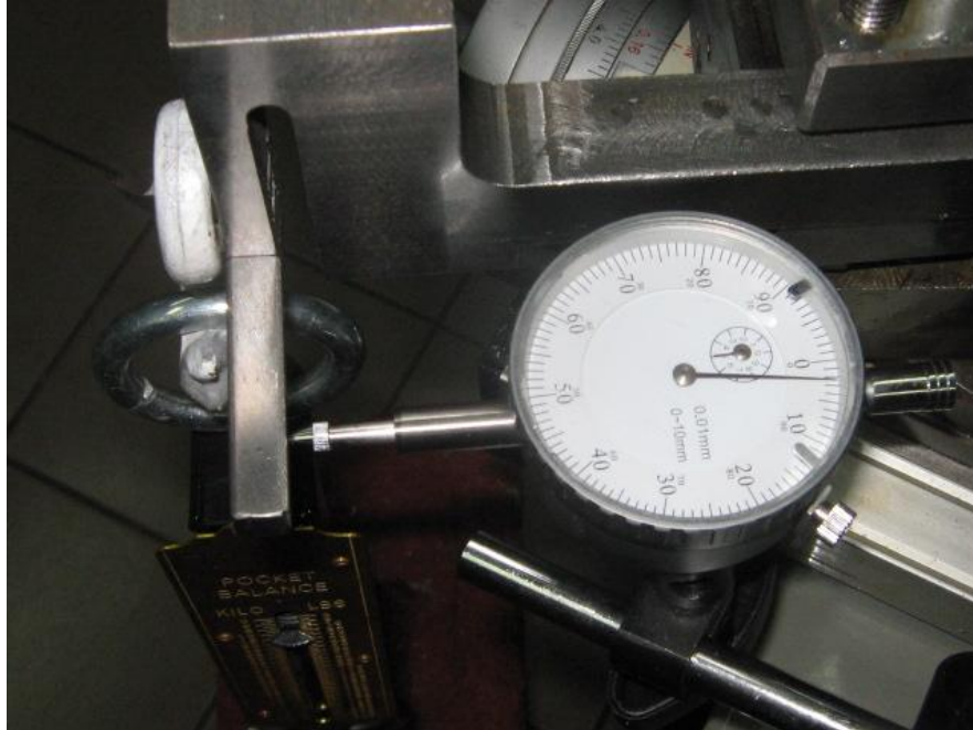
Figura 84. Deformación del dinamómetro con peso de 12 kgf
