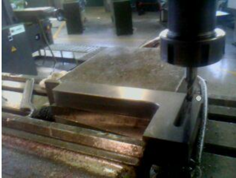
Figura 71. Mecanizado de la ranura
