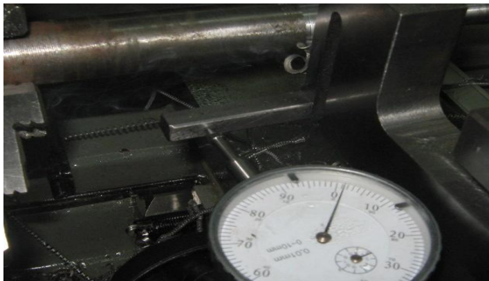
Figura 97. Deformación del dinamómetro con buril HSS con w = 1 mm
