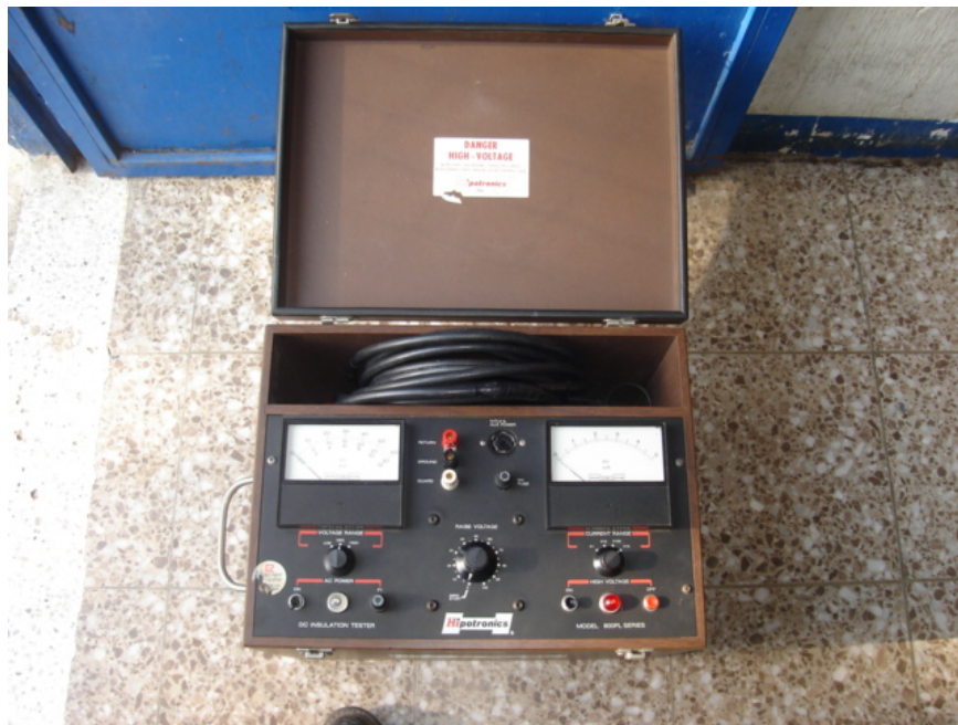
Figura 64. Equipo de Hipot utilizado para pruebas de cables.
