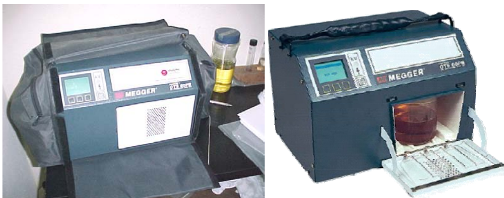
Figura 81. Analizador de aceite dieléctrico.
